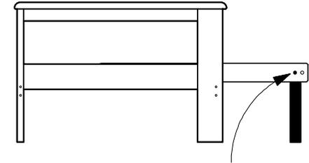
Using the extra 50mm bolts, attach the Queen short legs to the back deck. Utiliser les vis (50mm) supplémentaires, attacher les petites pattes "Queen" au châssis du dossier.
