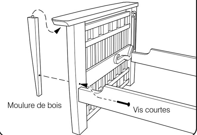
**3A** Avec précaution, monter en position le dossier au châssis. Placer les tiges du bas sur la moulure de caoutchouc "Sea Horse".
